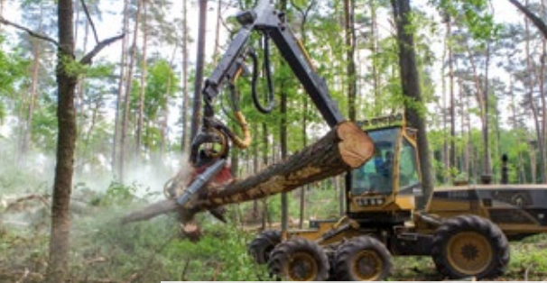
Der Harvester fällt eine knapp 30 m hohe Kiefer in 35 Sekunden
