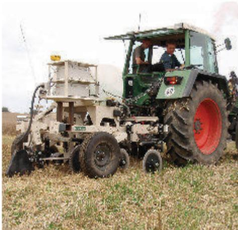
Foto: Dr. Robin Gebbers, „ATB – Prototyp einer Sensorkombination zur Bestimmung von Boden-pH und Humusgehalt“
